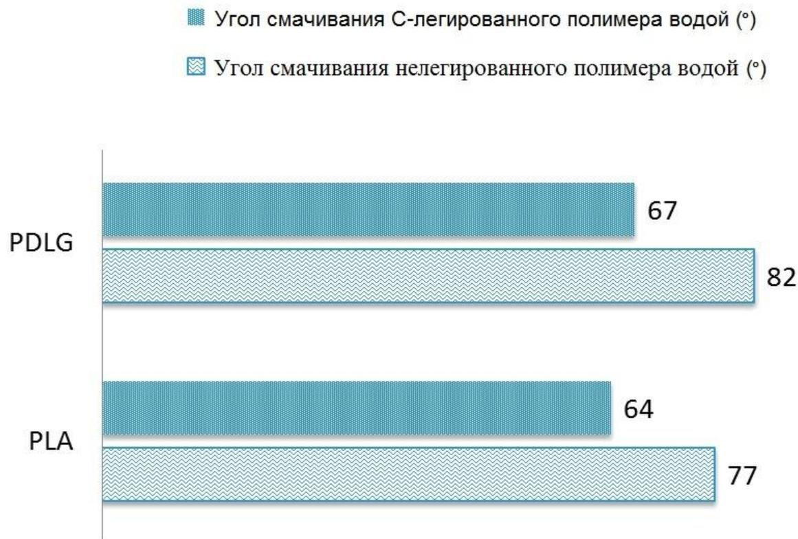
Диаграмма, отражающая величину угла смачивания до и после модификации поверхности образца полимера
